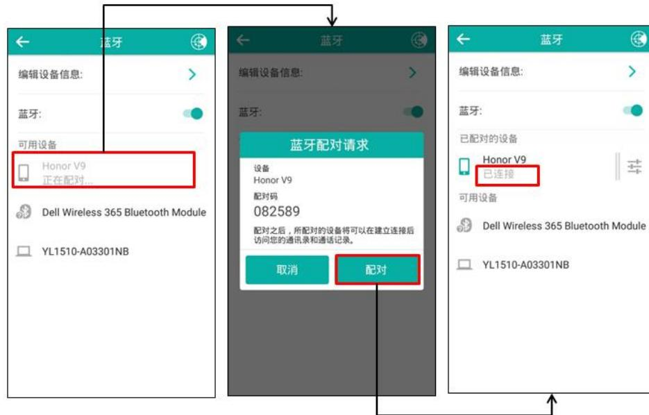
触摸屏的状态栏显示蓝牙手机图标
