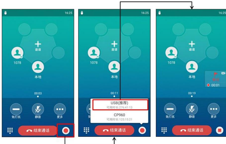
开始录音后 , 录制图标变成
