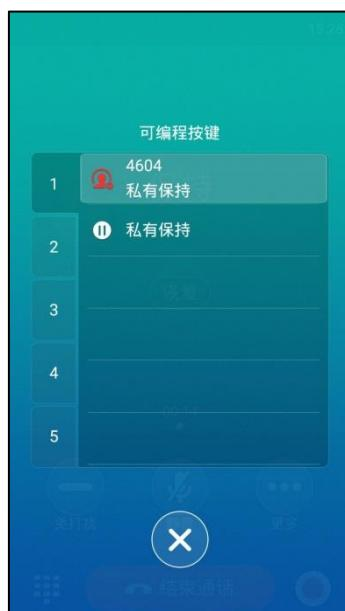
话机 A 的账号键 1 显示 “私有保持”，图标显示为
