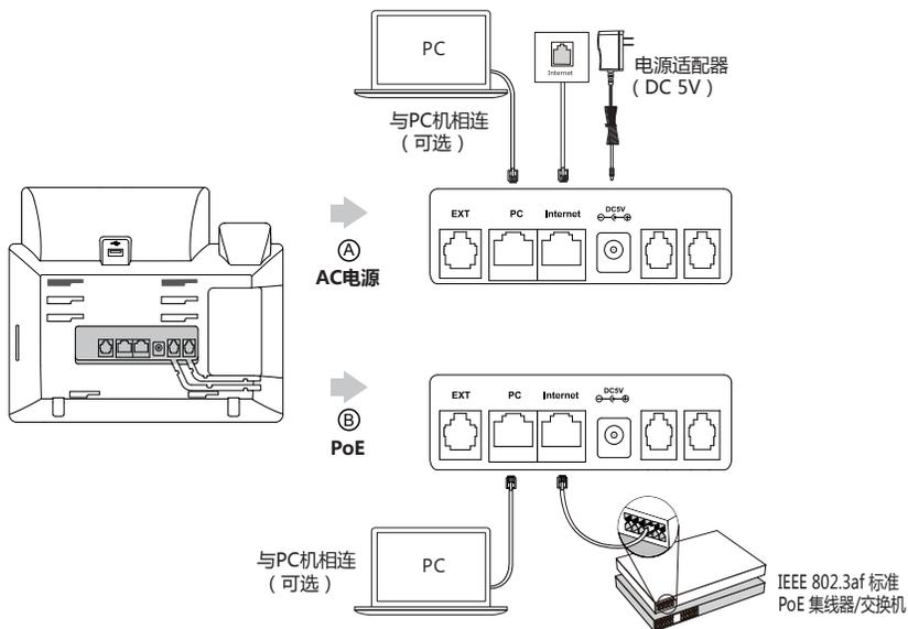
**说明：**我们要求使用Yealink原装电源（5V/2A），使用第三方电源可能会导致话机损坏。如果你的话机需要与PC机相连，建议使用Yealink标配的网线。
