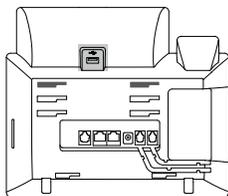
**说明：**USB设备需要另外购买。想要了解更多关于如何使用蓝牙适配器BT40和无线适配器WF40，请参阅 Yealink Bluetooth USB Dongle BT40 User Guide和Yealink Wi-Fi USB Dongle WF40 User Guide。
