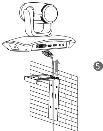
6. 将一体机锁在 L 型支架上，并将 DVI 线的另一端连接在接线盒的 DVI 接口上。
