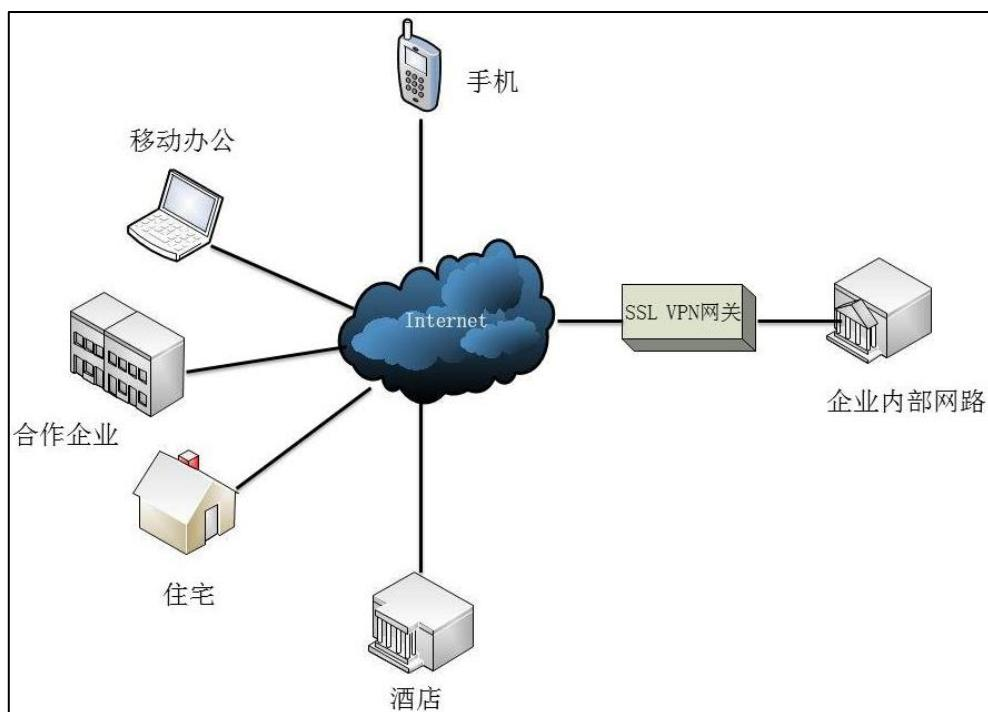
OpenVPN 是一个功能全面的 SSL VPN 软件解决方案 , 在远程访问中创建安全的连接。 OpenVPN 的技术核心是虚拟网卡 , 虚拟网卡是使用网络底层编程技术实现的一个驱动软件。终端支持 TUN 与 TAP 模式的虚拟网卡。 TAP 模拟链路层设备 , 提供虚拟的点对点连接。 TUN 模拟网络层设备 , 提供一个虚拟的网段。为了防止泄露私人信息 , 在建立安全的 VPN 隧道之前 , 隧道的两个端点必须先相互进行身份验证。在终端上正确配置 VPN 功能后 , 终端作为 VPN 客户端 , 使用证书与 VPN 服务器进行身份验证。
