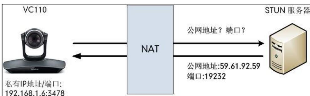
抓包可以看到 VC110 会议电视终端向 STUN 服务器发送 Binding 请求 ,STUN 服务器回复映射的地址和端口: Binding Success Response MAPPED-ADDRESS:
