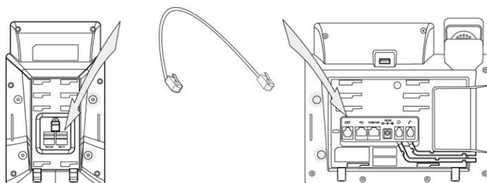
如果你连接两个扩展台，将另一连接线的一端连接在第一个扩展台的 EXT out 接口上，另一端连接到第二个扩展台的 EXT in 的接口。
