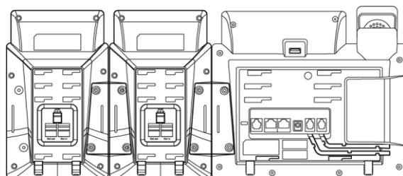
3. 将连接线的一端连接在话机的 EXT 接口上，另一端连接到 EXP40 的 EXT in 的接口。
