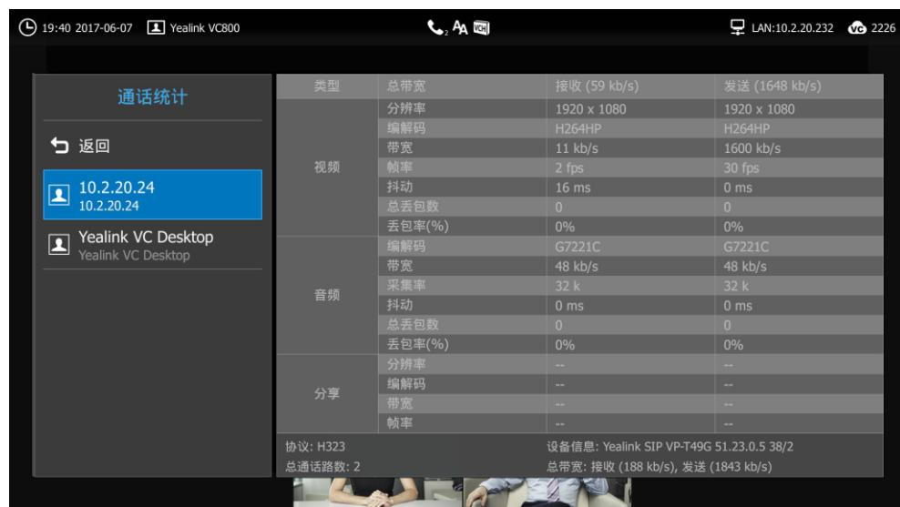
如果丢包较多，建议进一步确认是由于两地之间的运营商网络稳定性问题还是由于内部共享上网，造成概率性网络拥塞。如果是由于内部共享上网，导致的网络拥塞，建议使用流控设备对会议电视终端视频会议的流量进行带宽保障，保障视频会议带宽的稳定性。
