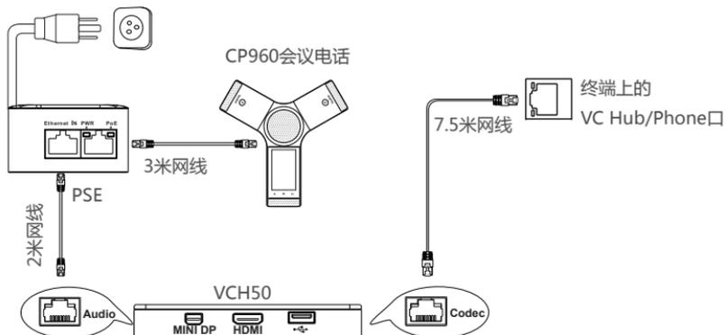
💡 如果你无需使用VCH50进行演示，可以将CP960会议电话的PSE直接连在终端的VC Hub/Phone接口上。
