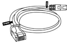
用带有 Audio In 标签的 7.5 米网线将 VCM30 有线阵列麦克风连接到接线盒上 ,VCM30 有线阵列麦克风可以作为终端的音频输入设备。想要了解更多 , 请参阅第 177 页的 [音频输入设备](#)。
