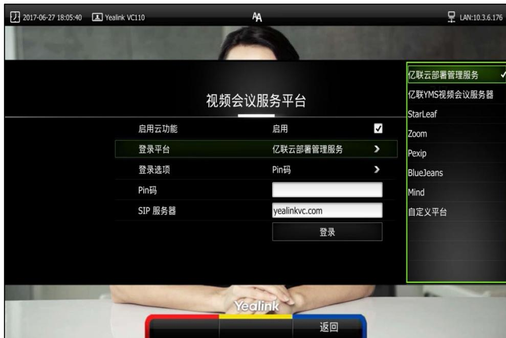
13. 登录平台后，按遥控器上的
