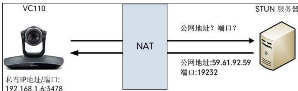
抓包可以看到 VC110 会议电视终端向 STUN 服务器发送 Binding 请求 ,STUN 服务器回复映射的地址和端口: Binding Success Response MAPPED-ADDRESS:
