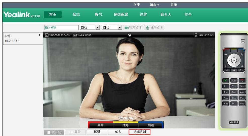
2. 点击虚拟遥控器上的按键对视频会议终端进行远端控制。
