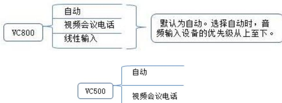
终端的音频输入设备类型默认为**自动**，如果当前有多种可用的音频输入设备连接到 VC800/VC500 终端上，终端在通话中自动选择优先级高的音频输入设备。
