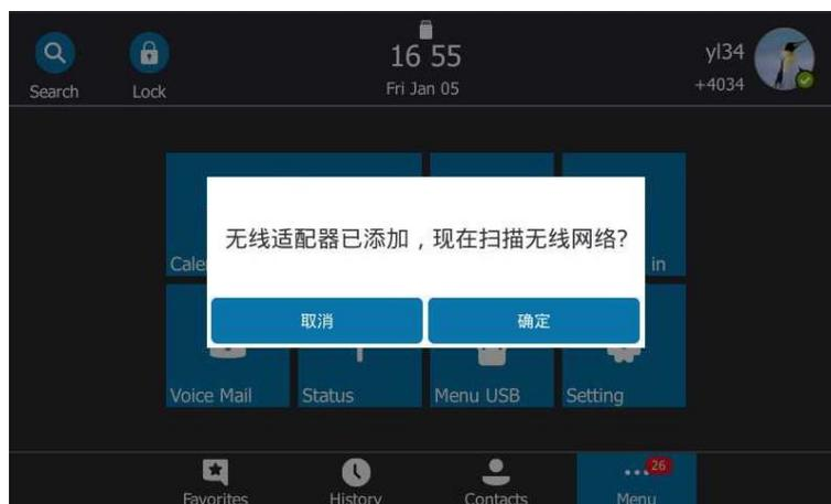
你可以按**确定**软键直接激活 Wi-Fi 模式并且话机自动搜索可用的 Wi-Fi 设备。如果你按**取消**软键，当你想要使用 Wi-Fi 功能时可手动开启 Wi-Fi 模式。
