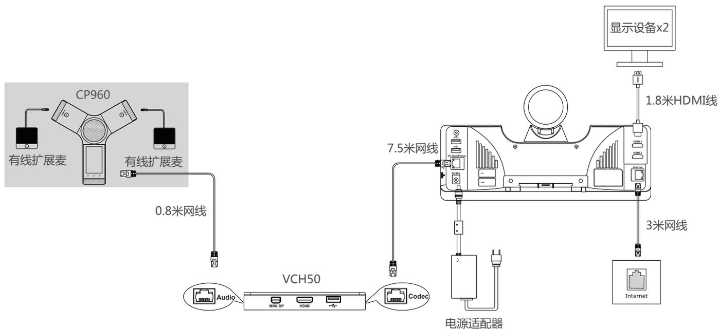
💡 如果你无需使用VCH50进行演示，可以使用7.5米网线将CP960会议电话的Internet接口直接连在终端的VC Hub/Phone接口上。
