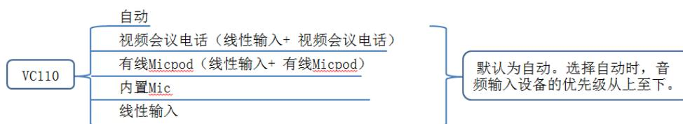
终端的音频输入设备类型默认为**自动**，如果当前有多种可用的音频输入设备连接到 VC110 终端上，终端在通话中自动选择优先级高的音频输入设备。
