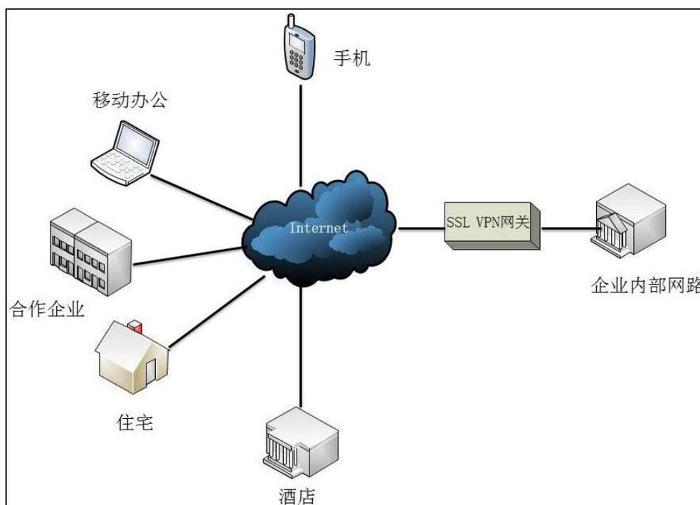
OpenVPN 是一个功能全面的 SSL VPN 软件解决方案, 在远程访问中创建安全的连接。OpenVPN 的技术核心是虚拟网卡, 虚拟网卡是使用网络底层编程技术实现的一个驱动程序。终端支持 TUN 与 TAP 模式的虚拟网卡。TAP 模拟链路层设备, 提供虚拟的点对点连接。TUN 模拟网络层设备, 提供一个虚拟的网段。为了防止泄露私人信息, 在建立安全的 VPN 隧道之前, 隧道的两个端点必须先相互进行身份验证。在终端上正确配置 VPN 功能后, 终端作为 VPN 客户端, 使用证书与 VPN 服务器进行身份验证。
