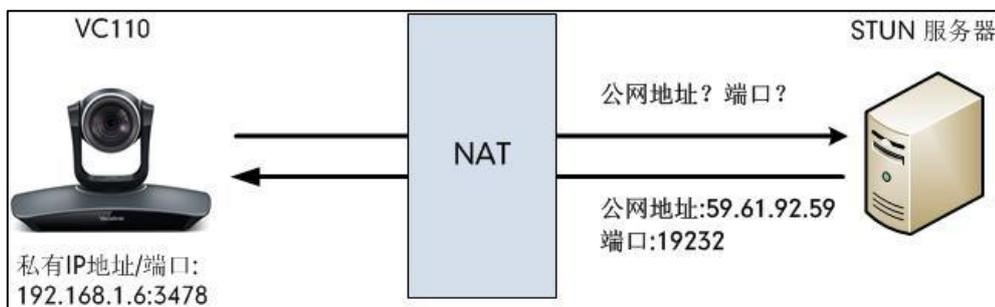
抓包可以看到 VC110 会议电视终端向 STUN 服务器发送 Binding 请求, STUN 服务器回复映射的地址和端口: Binding Success Response MAPPED-ADDRESS: 59.61.92.59:19232
