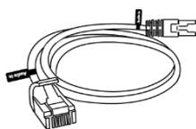
用带有 Audio In 标签的 7.5 米网线将 VCM30 有线阵列麦克风连接到接线盒上，VCM30 有线阵列麦克风可以作为终端的音频输入设备。想要了解更多，请参阅第 139 页的 [音频输入设备](#)。
