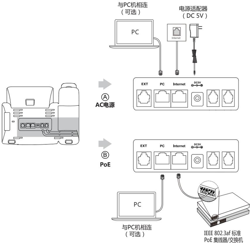
**说明：**我们要求使用Yealink原装电源（5V/1.2A），使用第三方电源可能会导致话机损坏。如果你的话机需要与PC机相连，建议使用Yealink标配的网线。
