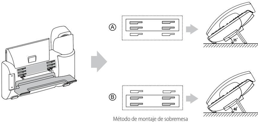
Nota: También puede montar el teléfono en una pared. Para más información sobre cómo fijar el soporte de montura para pared, consulte la Guía de instalación rápida de soportes de montura para pared Yealink para teléfonos IP Yealink.
