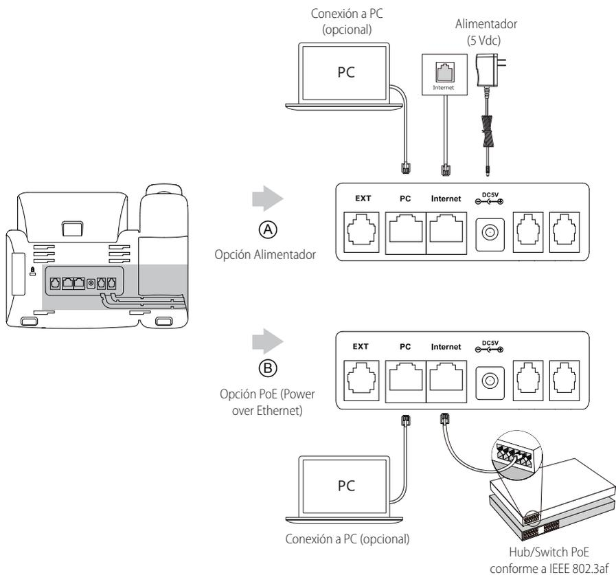
**Nota:** Sólo se debe usar el teléfono IP con un alimentador original (5V/1,2A) de Yealink. El uso de alimentadores de terceros puede causar daños irreparables en el equipo. Si quiere conectar un PC al terminal, le recomendamos usar el cable Ethernet proporcionado por Yealink.
