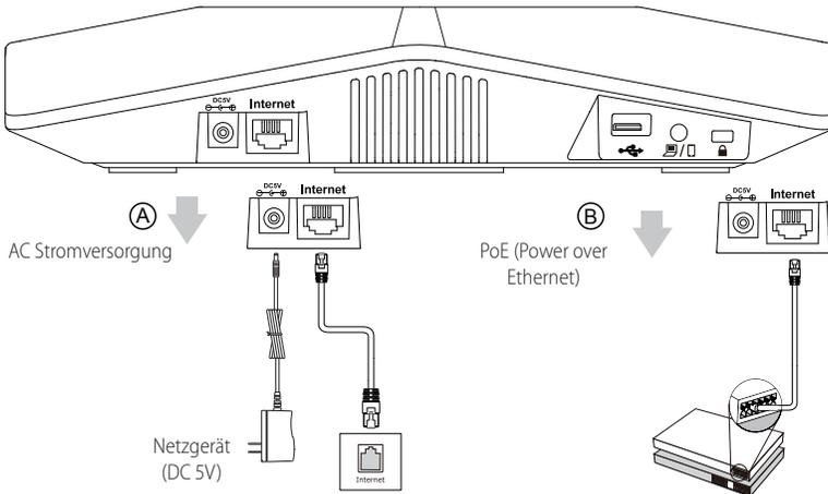
Hinweis: Das IP-Telefon darf nur mit dem Original-Netzteil (5V/2A) von Yealink verwendet werden. Die Nutzung von Netzteilen, die von Drittanbietern geliefert wurden, kann zu einer Beschädigung des Telefons führen. Bei einer Online-Versorgung (PoE) muss das Netzgerät nicht angeschlossen werden. Vergewissern Sie sich, dass der Netzwerk-Switch PoE-kompatibel ist.
