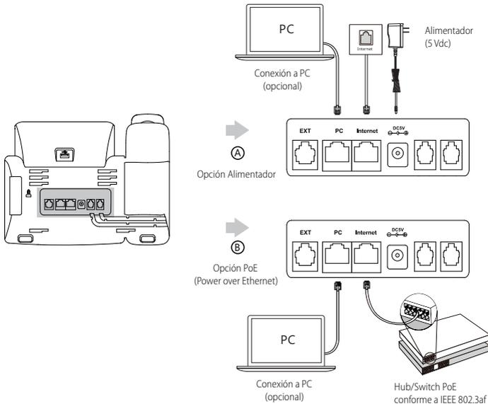
Nota: Sólo se debe usar el teléfono IP con un alimentador original (5V/2A) de Yealink. El uso de alimentadores de terceros puede causar daños irreparables en el equipo. Si quiere conectar un PC al terminal, le recomendamos usar el cable Ethernet proporcionado por Yealink. Si se proporciona alimentación en línea (PoE), no necesita conectar el alimentador. Asegúrese de que el hub/switch es compatible con PoE.
