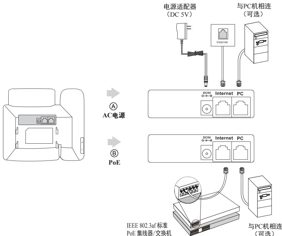
**说明：**我们要求使用Yealink原装电源（5V/600mA），使用第三方电源可能会导致话机损坏。
