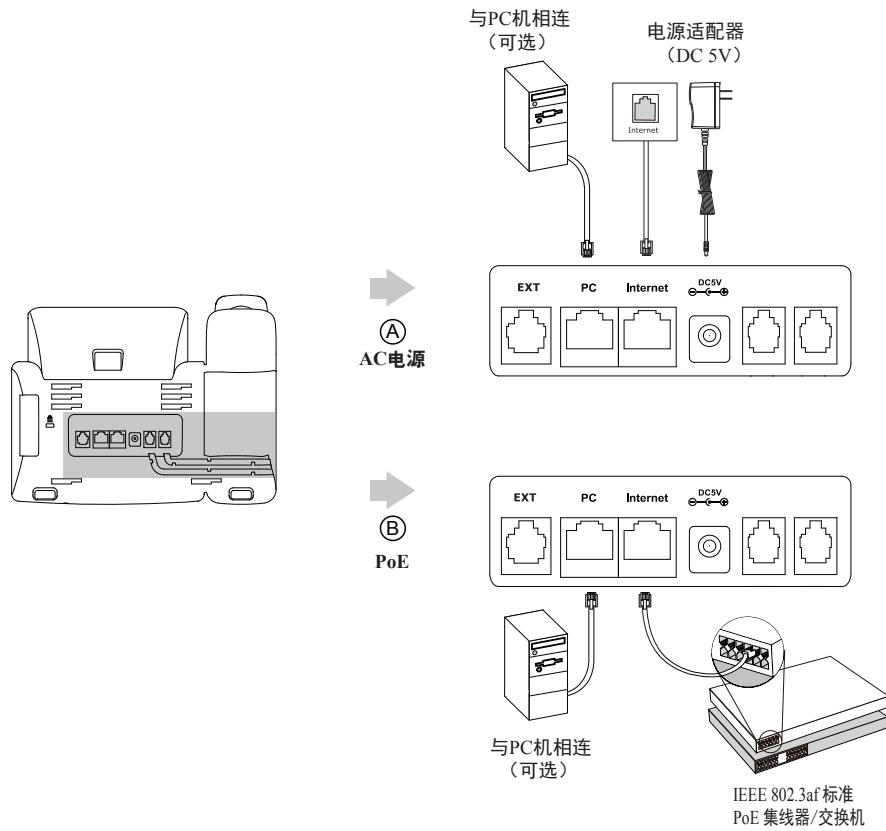
**说明：**我们要求使用Yealink原装电源（5V/1.2A），使用第三方电源可能会导致话机损坏。
