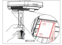
当支架接触到限位点,还不能放置在电视顶上时,请取出支架反向装配。请参阅下文了解更多信息。
