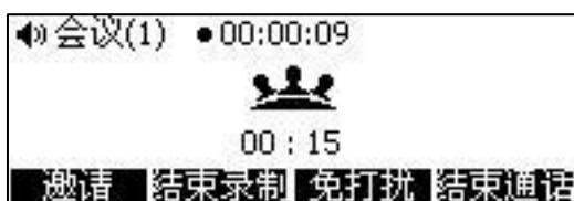
按遥控器上的 **\*.REC** 或 VCP40 话机上的**结束录制**软键停止录制。
