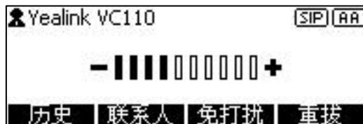
显示设备屏幕左侧同时显示终端当前的响铃音量。
