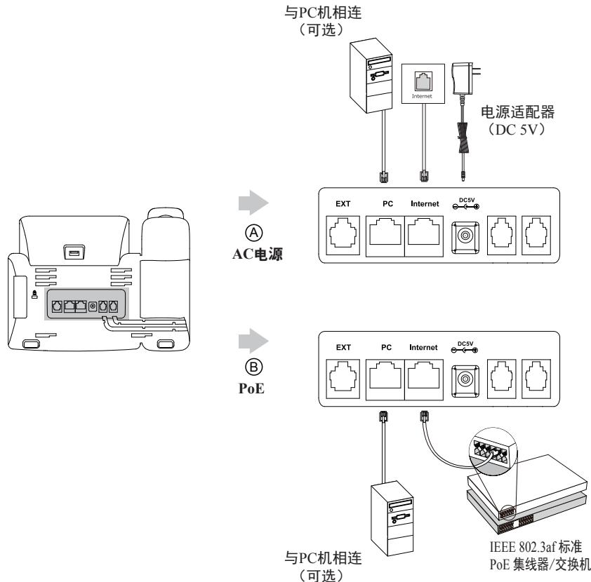
**说明：**如果使用PoE供电方式，话机不需要连接电源适配器。确保交换机/集线器支持PoE供电。
