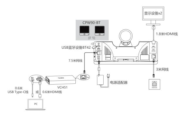
我们要求使用Yealink原装电源(48V/0.7A),使用第三方电源可能会导致终端损坏。如果使用过程中发现线缆破皮,请立即更换。
