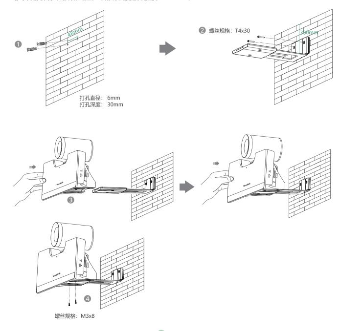
步骤: ① 在墙上打孔,将膨胀螺栓固定至墙上。
