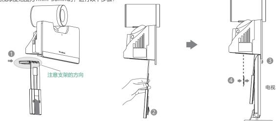
步骤: ① 将支架沿着终端底部轨道推至合适的位置。
