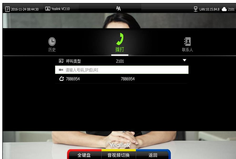
4. 按遥控器上的
