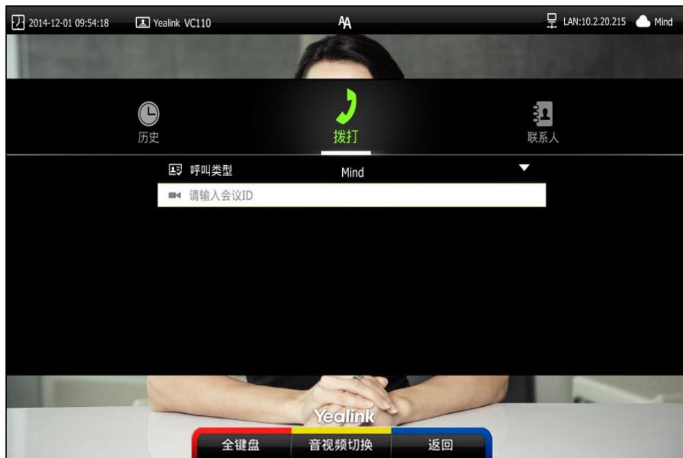
4. 按遥控器上的
