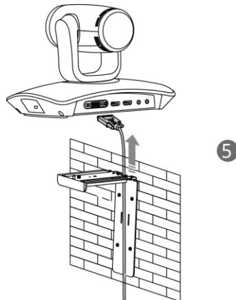
6. 将 VC110 一体机锁在 L 型支架上，并将 DVI 线的另一端连接在接线盒的 DVI 接口上。
