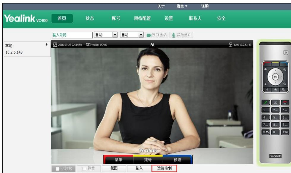
2. 点击虚拟遥控器上的按键对视频会议终端进行远端控制。
