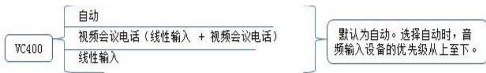
终端的音频输入设备类型默认为**自动**，如果当前有多种可用的音频输入设备连接到VC400终端上，终端在通话中自动选择优先级高的音频输入设备。
