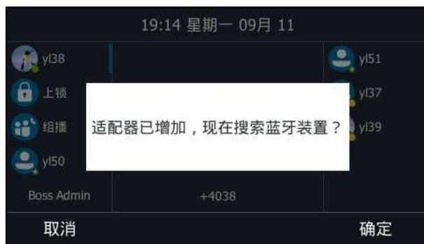
你可以按**确定**软键进入蓝牙设置界面。如果你选择**取消**，下次需要使用蓝牙功能时，请通过以下方式进入蓝牙设置界面。
