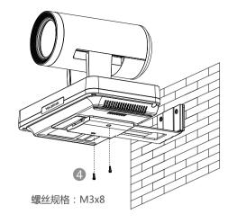
步骤: ● 在墙上打孔,将膨胀螺栓固定至墙上。
