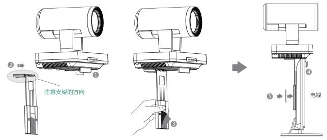
步骤: 1 打开终端底部的挡板。
