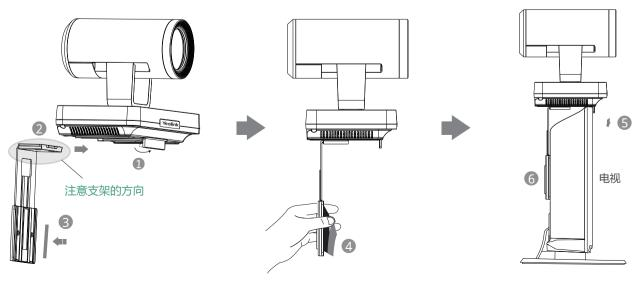
步骤: 1 打开终端底部的挡板。
