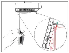
当支架与底壳箭头位置齐平,还不能放置在电视顶上时,请使用其他安装方式。 电视厚度超过100mm时,请勿使用挂装方式,机器 有跌落风险。
