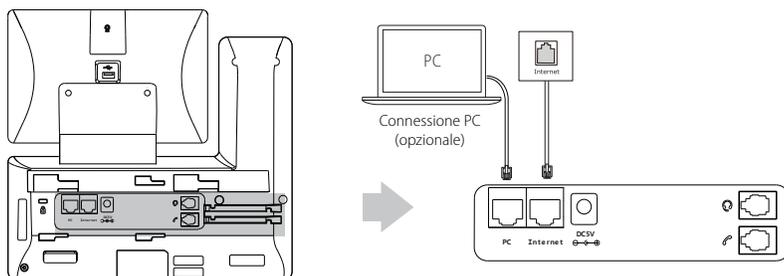
Nota: In caso di collegamento PC-telefono si raccomanda di utilizzare il cavo Ethernet fornito da Yealink.
