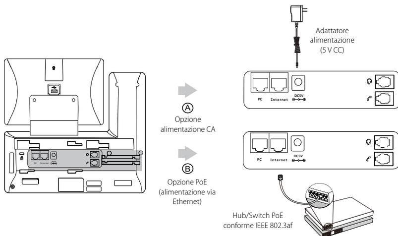
Nota: L'apparecchio telefonico IP deve essere utilizzato soltanto con adattatore originale Yealink (5 V/2 A). L'utilizzo di adattatori di terze parti può danneggiare il telefono.
