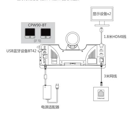
♀ 我们要求使用Yealink原装电源(48V/0.7A),使用第三方电源可能会导致终端损坏。如果使用过程中发现线缆破皮,请立即更换。
