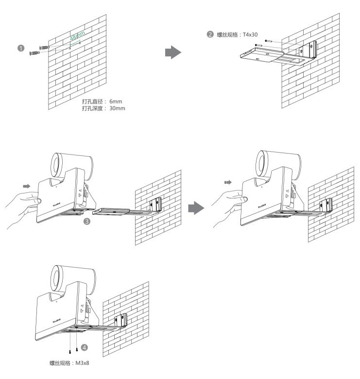
步骤: 1 在墙上打孔,将膨胀螺栓固定至墙上。
