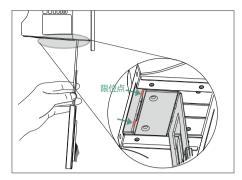
当支架接触到限位点,还不能放置在电视顶上时,请取出支架反向装配。请参阅下文了解更多信息。
