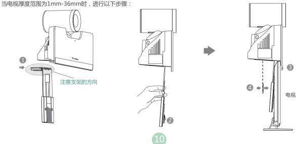
步骤: 1 将支架沿着终端底部轨道推至合适的位置。
