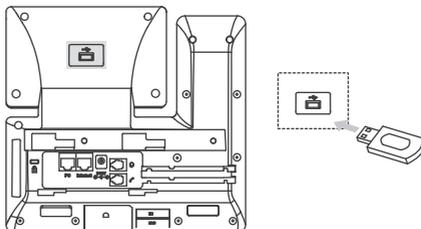
Remarque: Le port USB peut être également utilisé avec le dongle WIFI USB WF40, le module d'extension à écran couleur EXP50 et un casque USB. Le dongle WIFI USB WF40 et le module d'extension à écran couleur EXP50 peuvent être acheté séparément. Pour plus d'informations sur l'utilisation de ces WF40 et EXP50, se référer à leur guide d'utilisation. Pour plus d'information sur l'utilisation du casque USB, se référer à la documentation du constructeur.
