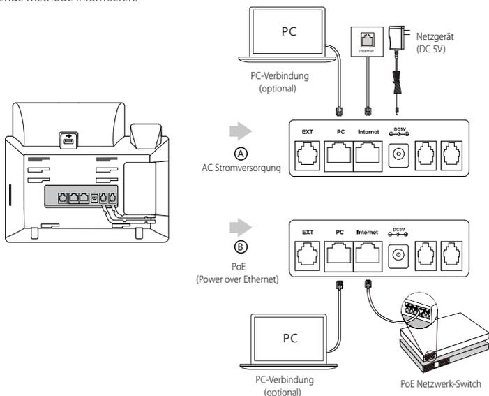
Hinweis: Das IP-Telefon darf nur mit dem originalen Yealink Netzteil (5V/2A) genutzt werden. Die Verwendung eines Netzteiles eines Drittanbieters kann zu einer Beschädigung des Telefons führen. Falls Sie beabsichtigen, Ihr Telefon mit einem PC zu verbinden, empfehlen wir, daß Sie das von Yealink gelieferte Ethernet-Kabel benutzen. Bei einer Online-Versorgung (PoE) muss das Netzgerät nicht angeschlossen werden. Vergewissern Sie sich, dass der Netzwerk-Switch PoE-kompatibel ist.
