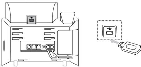
Hinweis: Die USB-Schnittstelle kann auch genutzt werden, um den Bluetooth-USB-Dongle BT40 oder den Wi-Fi-USB-Dongle WF40 anzuschließen. Der Bluetooth-USB-Dongle BT40 und der Wi-Fi-USB-Dongle WF40 müssen separat erworben werden. Weiterführende Informationen bezüglich der Nutzung von BT40 und WF40 sind in den Anwender-Handbüchern „Yealink Bluetooth USB Dongle BT40“ und „Yealink Wi-Fi USB Dongle WF40“ zu finden.
