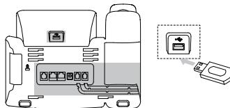
**说明：**USB接口也可用来连接蓝牙适配器BT40或无线适配器WF40。蓝牙适配器BT40或无线适配器WF40需要另外购买。想要了解更多关于如何使用蓝牙适配器BT40和无线适配器WF40，请参阅 Yealink Bluetooth USB Dongle BT40 User Guide 和 Yealink WiFi USB Dongle WF40 User Guide。
