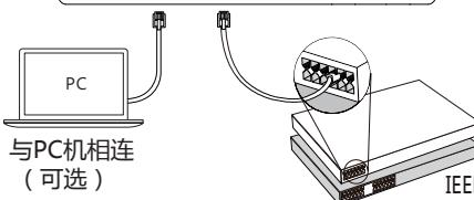
**说明：**我们要求使用Yealink原装电源(5V/2A)，使用第三方电源可能会导致话机损坏。如果你的话机需要与PC机相连，建议使用Yealink标配的网线。
