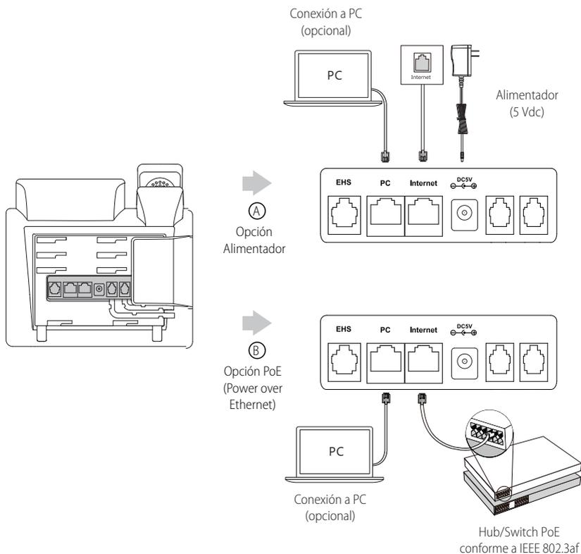
Nota: Utilice siempre el adaptador original de Yealink (5V/1,2A). El uso de alimentadores de terceros puede causar daños irreparables en el equipo. Si quiere conectar un PC al terminal, le recomendamos usar el cable Ethernet proporcionado por Yealink. Si se proporciona alimentación en línea (PoE), no necesita conectar el alimentador. Asegúrese de que el hub/switch es compatible con PoE.
