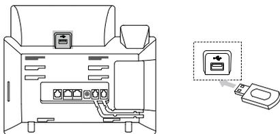
**说明：**USB接口也可用来连接蓝牙适配器BT40或无线适配器WF40。蓝牙适配器BT40和无线适配器WF40需要另外购买。想要了解更多关于如何使用蓝牙适配器BT40和无线适配器WF40，请参阅 [Yealink Bluetooth USB Dongle BT40 User Guide](#)和[Yealink Wi-Fi USB Dongle WF40 User Guide](#)。
