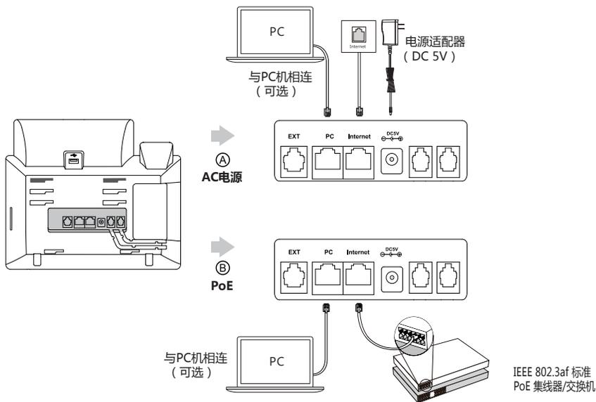
**说明：**我们要求使用Yealink原装电源（5V/2A），使用第三方电源可能会导致话机损坏。如果你的话机需要与PC机相连，建议使用Yealink标配的网线。如果使用PoE供电方式，话机不需要连接电源适配器。确保交换机/集线器支持PoE供电。
