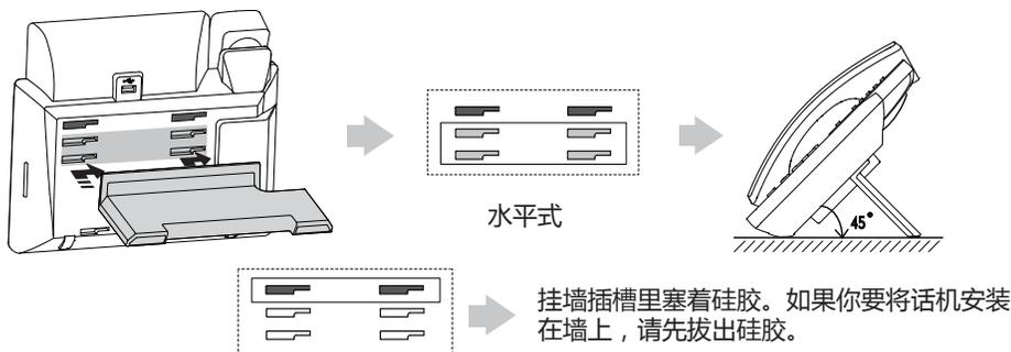
**说明：**你也可以将话机安装在墙上。想要了解更多关于挂墙式的安装信息，请参阅Yealink Wall Mount Quick Installation Guide。
