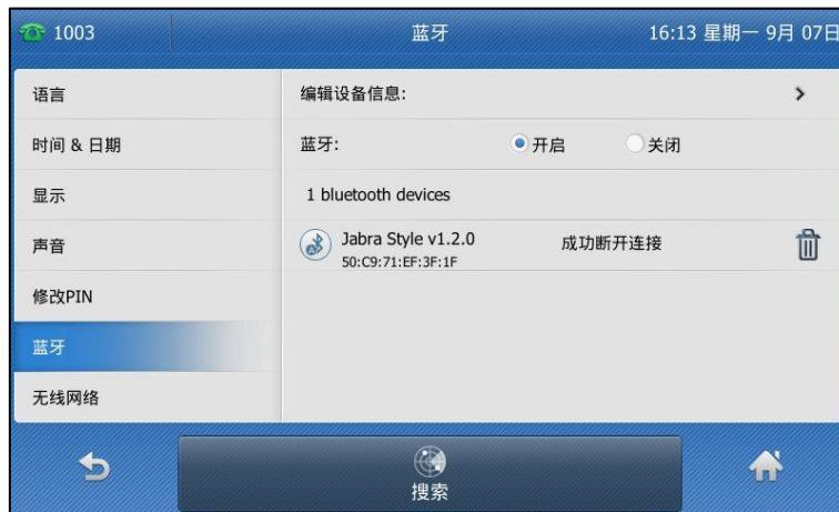
你可以从话机端搜索到的蓝牙设备删除蓝牙耳麦。删除之后，**bluetooth devices** 列表不再显示该蓝牙耳麦信息，想要再次使用该蓝牙设备需要重新搜索和连接。
