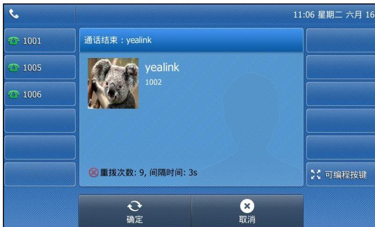
2. 按液晶屏上的**确定**软键或等待一段时间（重拨间隔时间），话机将重新呼出号码。
