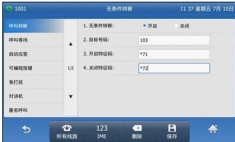
你也可以为所有账号启用无条件转移功能。在为特定的账号启用无条件转移功能后，执行以下操作：
