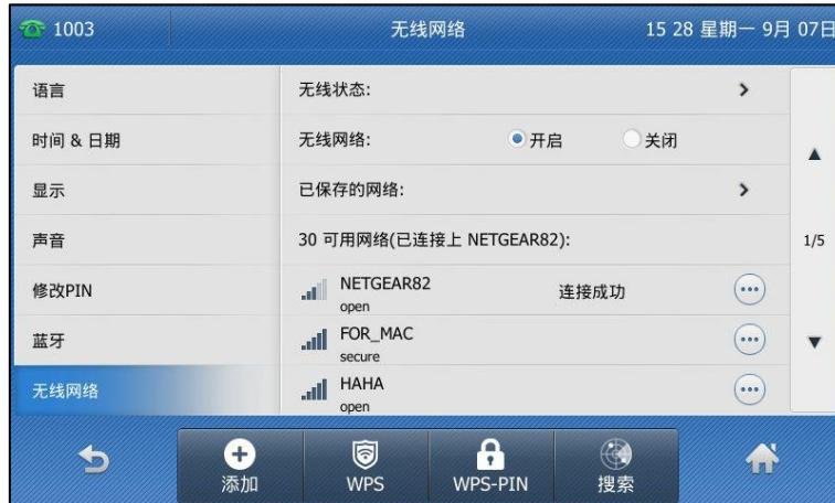
当无线网络适配器 WF40 插入到话机后端的 USB 接口后，液晶界面提示“无线适配器已添加，现在扫描无线设备？”。按确定自动开启无线网络模式并搜索无线信号。
