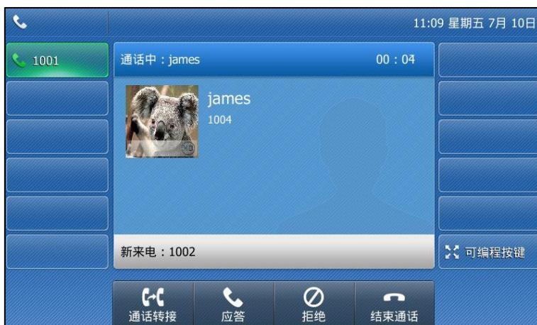
1. 按话机上的
