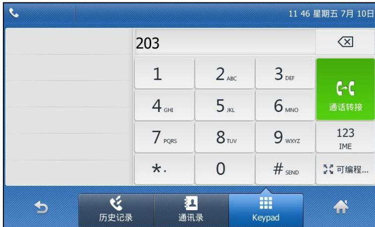
3. 按话机上的
