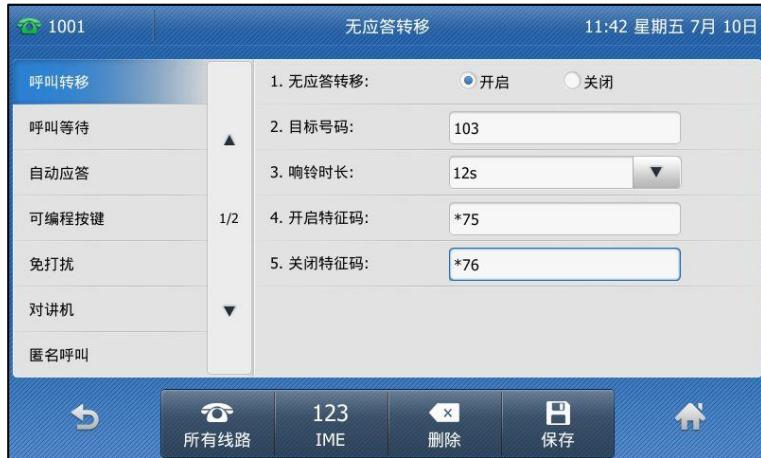
你也可以为所有账号启用无应答转移功能。在为特定的账号启用无应答转移功能后，执行以下操作：
