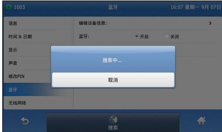
话机搜索附近的蓝牙设备。当搜索完后，话机的液晶界面列出所有搜索到的蓝牙设备，显示如下：
