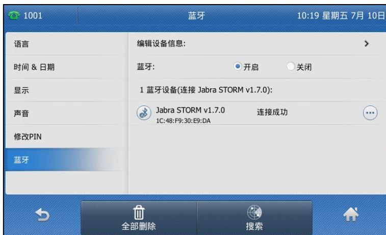
当蓝牙耳麦连接上话机后，你可以用蓝牙耳麦拨打电话或接听来电。想要了解更多信息，请参阅蓝牙耳麦厂商提供的使用说明书。
