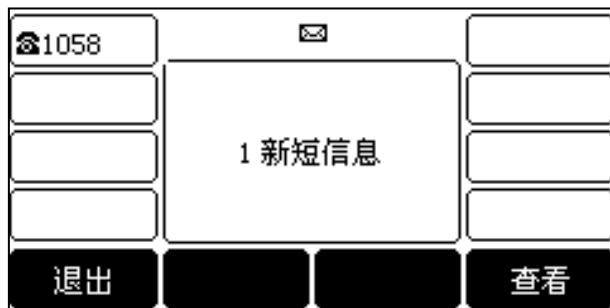
短信息可以储存在收件箱，已发信息，发件箱和草稿箱中，分别可以储存 100 条短信息。如果短信息的数量超过 100，话机将会直接删除最旧的短信息。
