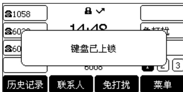
你必须知道解锁 PIN 码才能为话机解锁。默认的解锁 PIN 码为“123”。
