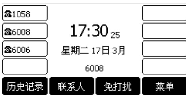
当你为账号键 9-21 配置功能时，账号键 8-14 的标签将会显示在第 2 页，账号键 15-21 的标签将显示在第 3 页。话机右边最下面的账号键用于切换页面，称为页面切换键。下图为多页标签的示例：
