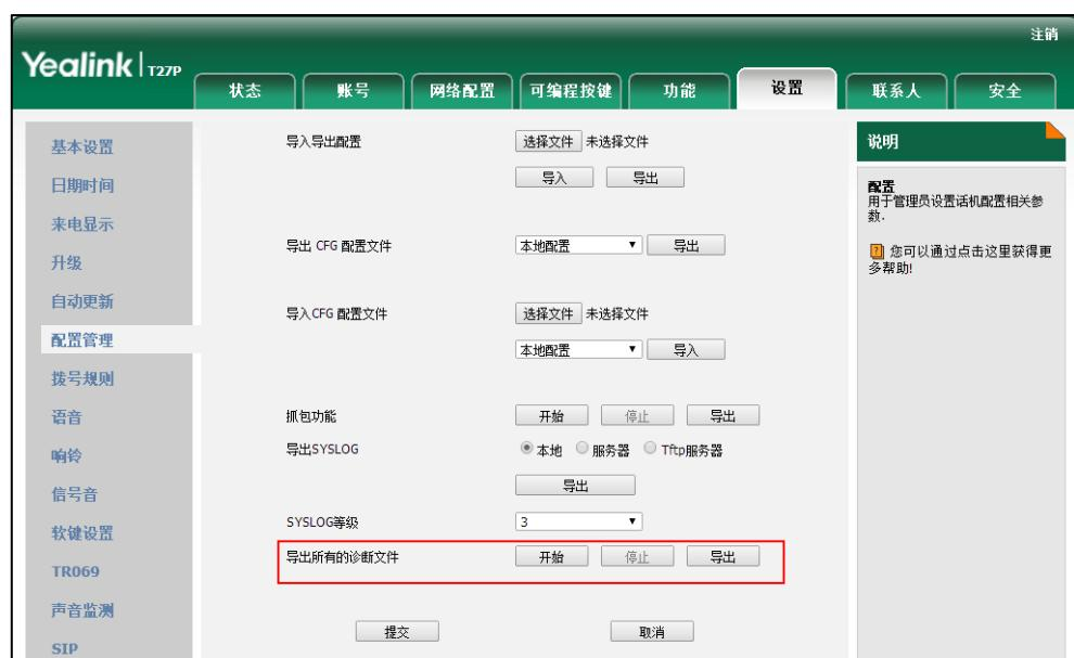
**说明** 如果错误无法重现，你可以点击**导出**直接导出所有诊断日志。
