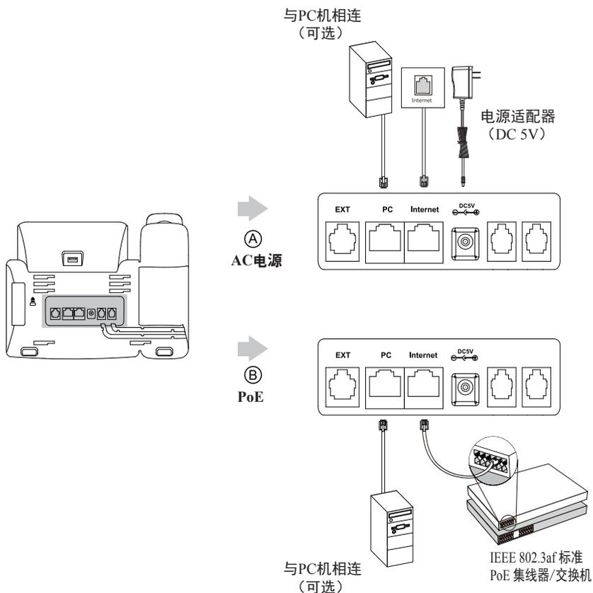
**说明：** 我们要求使用Yealink原装电源（5V/2A），使用第三方电源可能会导致话机损坏。
