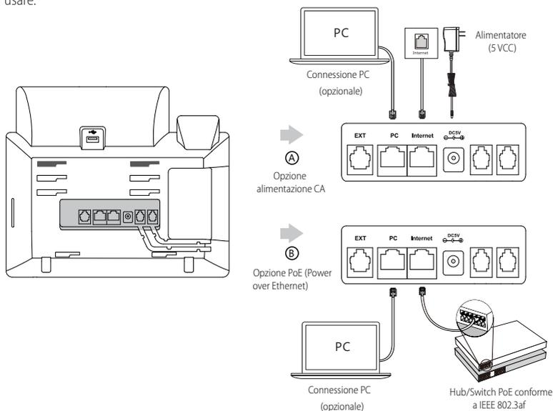
Nota: Il telefono IP va usato solo con l'adattatore di corrente originale Yealink (5V/2 A). L'uso dell'adattatore di alimentazione di terze parti può causare danni al telefono. Se si desidera collegare un PC al telefono, si consiglia di utilizzare il cavo Ethernet fornito da Yealink.
