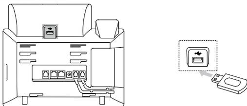
Nota: La porta USB può anche essere utilizzata per connettere il dongle Bluetooth BT40 o quello Wi-Fi WF40/WF50. I due dongle Bluetooth o Wi-Fi devono essere acquistati separatamente. Per maggiori informazioni sull'utilizzo del BT40, del WF40 del WF50 si può fare riferimento alle relative User Guide.
