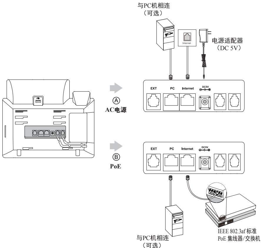
**说明：**如果使用PoE供电方式，话机不需要连接电源适配器。确保交换机/集线器支持PoE供电。
